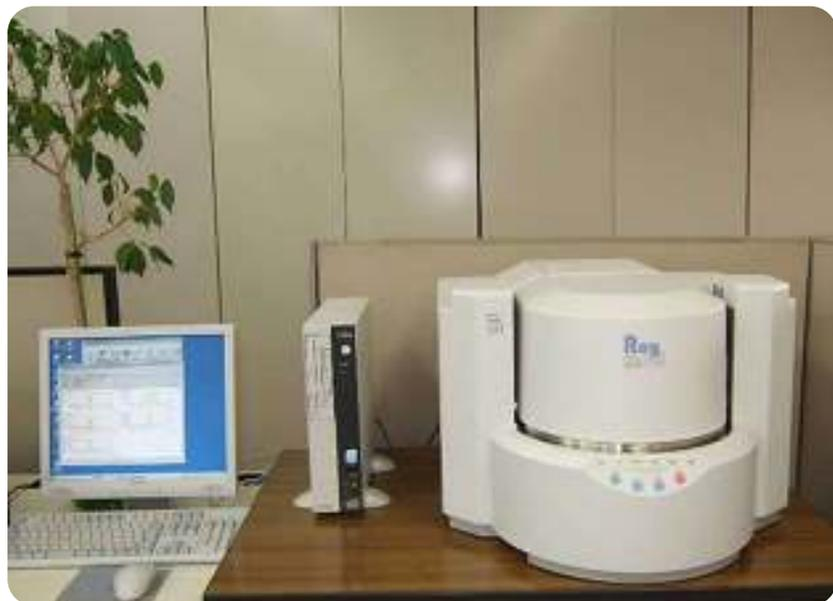
「蛍光X線分析装置」を導入し、製品に有害化学物質 (RoHS指令6物質) が含まれているか測定
